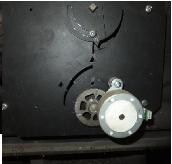
Regulácia sekundárneho vzduchu krokovým motorom
