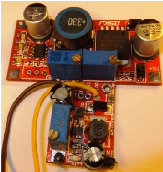
DC/DC UP a DOWN meniče použité na nabíjanie Supercap a LiPol článkov
