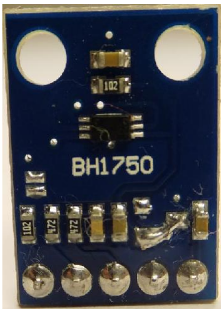
Obrázok 17: Senzor intenzity osvetlenia BH1750, bez stabilizátoru 3,3 V
